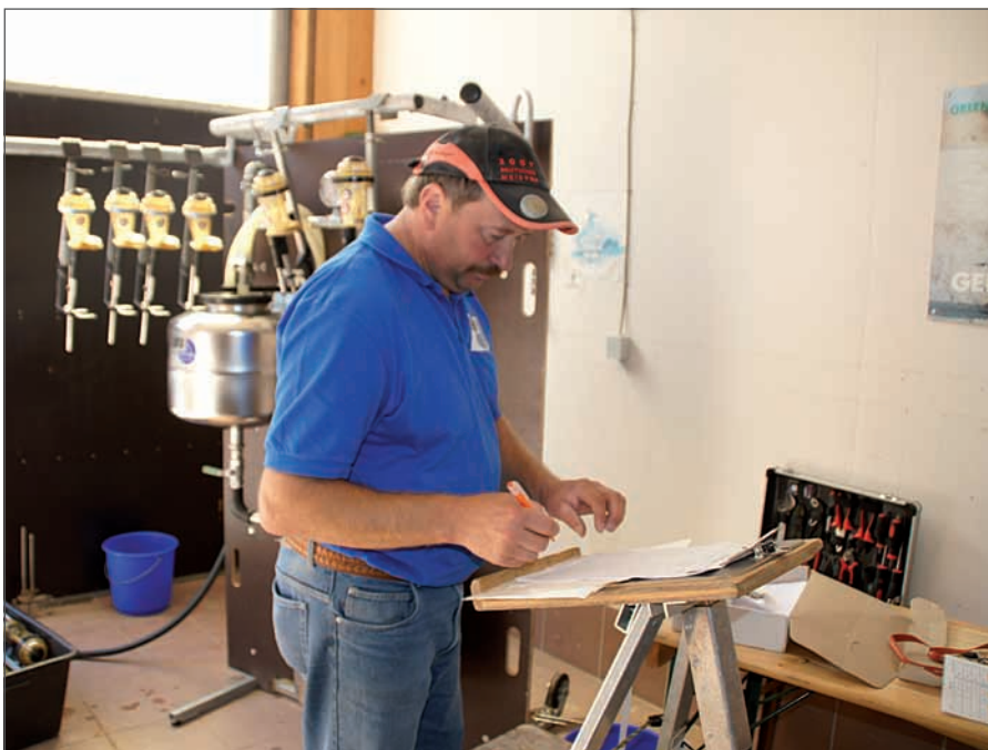
Überprüfung der Milchmengenmessgeräte mit der mobilen Prüfeinrichtung
