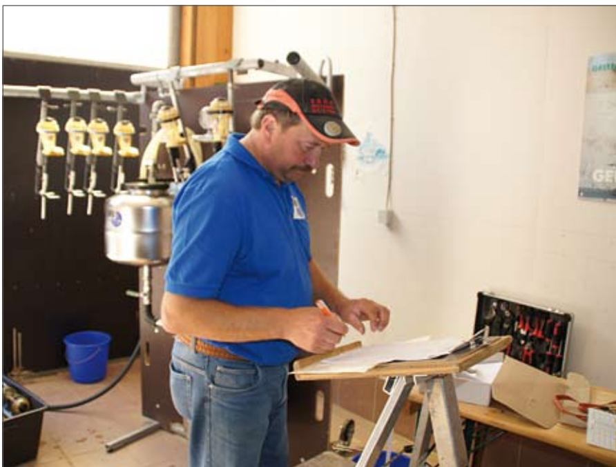
Überprüfung der Milchmengenmessgeräte mit der mobilen Prüfeinrichtung
