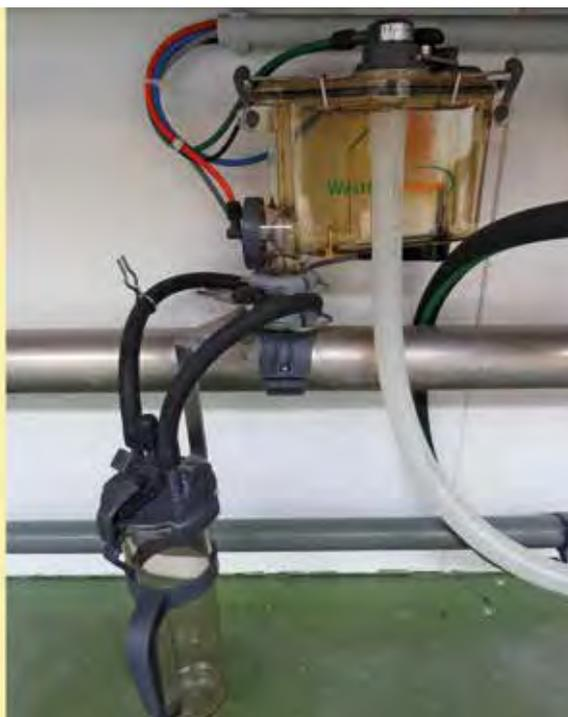
Stationäre elektronische Milchmengenmessgeräte, fest in Melkständen und automatischen Melksystemen eingebaut, müssen eine ICAR-Zulassung haben, wenn sie zur offiziellen Milchleistungsprüfung herangezogen werden sollen. Die meisten Melktechnikhersteller bemühen sich um eine solche Anerkennung. Auf Seite 91 dieses Berichtes sind die Geräte mit einer ICAR-Zulassung aufgeführt.
