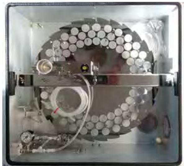
Elektronische Milchmengenmessgeräte, die bei der MLP eingesetzt werden, müssen durch den LKV nach den international gültigen Richtlinien einer jährlichen Routineüberprüfung unterzogen werden. Das Milchmengenmessgerät Ori-Collector kann zur MLP an verschiedenen Roboterfabrikaten angeschlossen werden.
