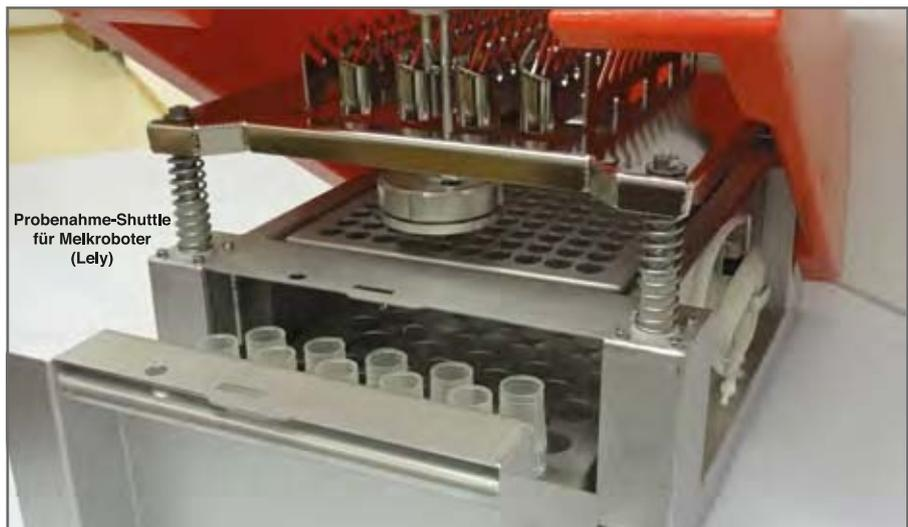
Probenahme-Shuttle für Melkroboter (Lely)
